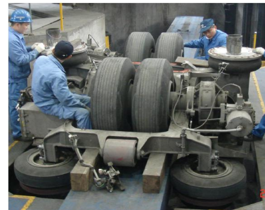
重庆单轨（日立大型）转向架（双轴四轮）
