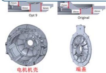
壳体壁厚调整 电机轴鼓型量修形
