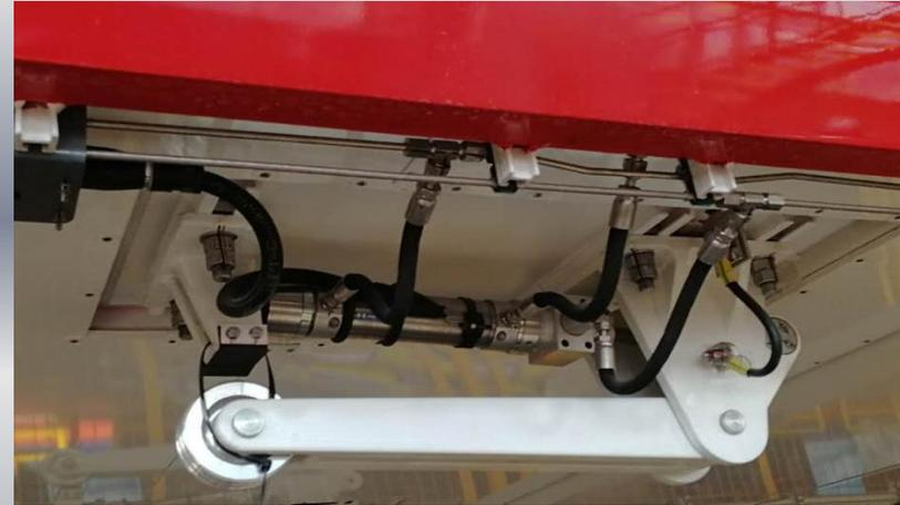
为解决车辆停站旅客上下车过程中的车辆稳定性，车体下部增加止摆装置，与站台上预设的齿板啮合，防止车辆晃动。
