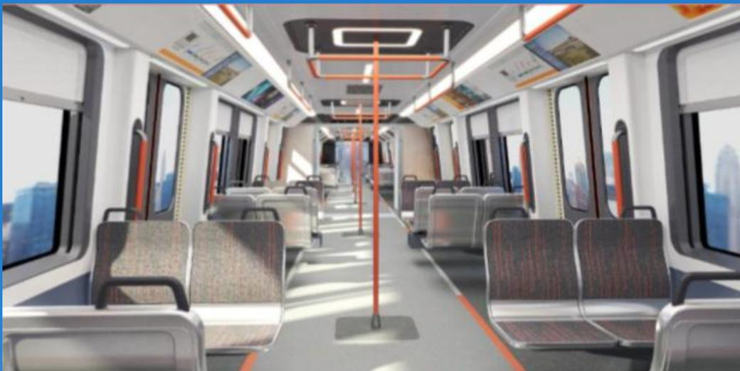
采用横排座椅设计，提高旅客舒适度，还可根据需求设计为纵排座椅，增加列车载客量。
