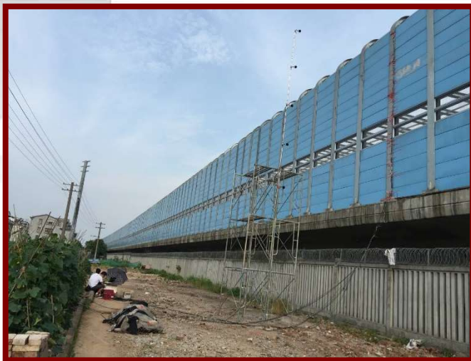
沪昆高铁半封闭声屏障降噪 现场试验 2015
