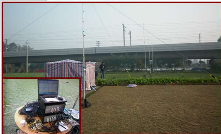
成灌铁路典型桥梁振动与噪声测试
